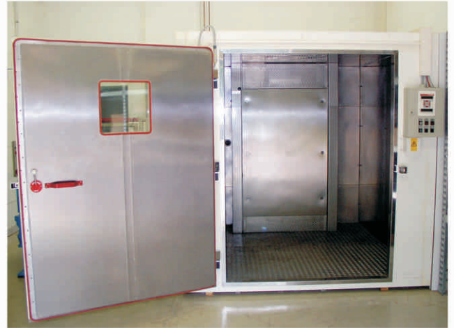
Abb.: begehbare Klimakammer Typ HCZ 3006 N
